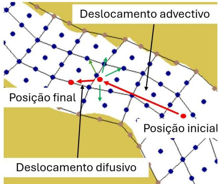
Figura 2.7: Desenho esquemático de um deslocamento composto por uma parte advectiva e outra difusiva. As setas verdes são os possíveis deslocamentos difusivos que não foram sorteados.
