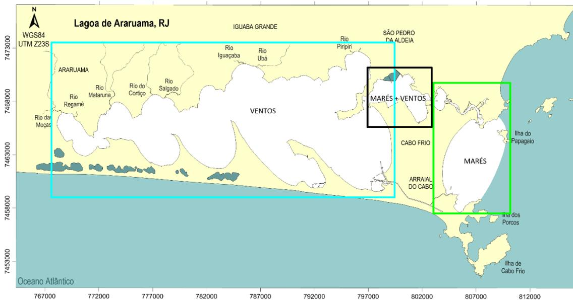
Figura 4.3: Lagoa dividida em macrorregiões com a identificação da principal forçante responsável pela circulação hidrodinâmica.
