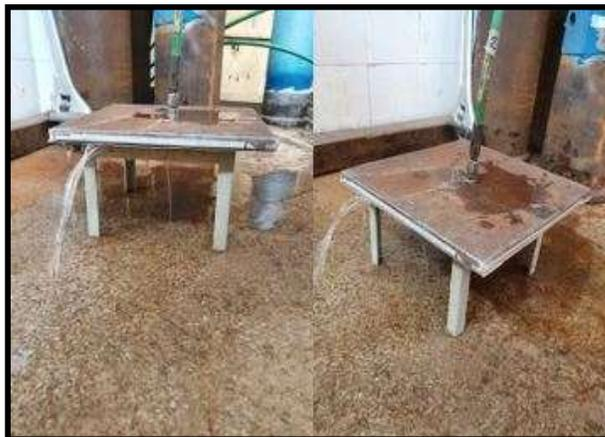
Figura 3.10 - Falha Típica (Descolamento), SATHLER(2021)
