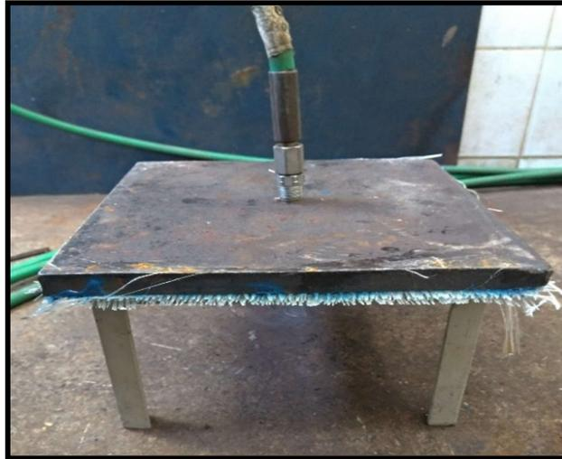
Figura 3.9 - Blister Test Pressurizado, 2021.
