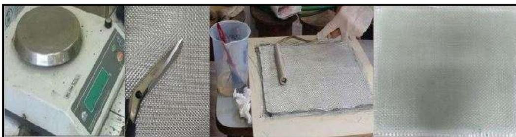
Figura 3.2 - Fabricação da placa de compósito laminado, SATHLER (2021).
