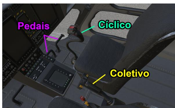
Figura 26 – Controles do helicóptero H125 Esquilo.
