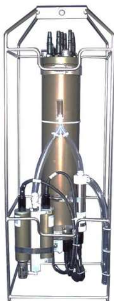
Figura 11 – Imagem ilustrativa de um CTD Sea Bird -9 – Fonte: https://www.seabird.com/sbe-911plus-ctd . Acesso em: 03 mar 2023.
